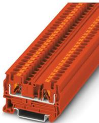
Borne de paso, tensión nominal: 800 V, corriente nominal: 32 A, número de conexiones: 2, tipo de conexión: Conexión push-in, Sección de dimensionamiento: 4 mm<sup>2</sup>, sección: 0,2 mm<sup>2</sup> - 6 mm<sup>2</sup>, clase de montaje: NS 35/7,5, NS 35/15, color: rojo
