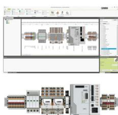
Software de planificación y marcado intuitivo para diseñar regleteros de bornes y para la rotulación profesional de materiales de marcado para bornes, conductores, equipos e instalaciones. El software está disponible para su descarga
