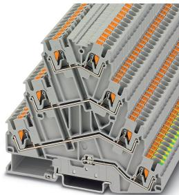
Borne para motores, cuatro pisos, tipo de conexión: conexión push-in, sección transversal: 0,14 mm<sup>2</sup> - 4 mm<sup>2</sup>, AWG: 26 - 12, ancho: 5,2 mm, altura: 91,1 mm, color: gris, tipo de montaje: NS 35/7,5, NS 35/15
