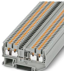
Borne para componentes, con diodo integrado 1N4007, tensión nominal: 800 V, corriente nominal: 0,5 A, número de conexiones: 4, tipo de conexión: Conexión push-in, 1er piso, Sección de dimensionamiento: 2,5 mm<sup>2</sup>, sección: 0,14 mm<sup>2</sup> - 4 mm<sup>2</sup>, clase de montaje: NS 35/7,5, NS 35/15, color: gris
