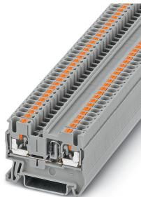
Borne para componentes, con diodo integrado 1N4007, tensión nominal: 800 V, corriente nominal: 0,5 A, tipo de conexión: Conexión push-in, sección: 0,14 mm<sup>2</sup> - 4 mm<sup>2</sup>, AWG: 26 - 12, longitud: 48,5 mm, anchura: 5,2 mm, color: gris, montaje: NS 35/7,5, NS 35/15
