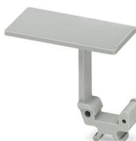
Indice para señalización de grupos, encajable en el centro del borne para bornes de conexión por tornillo, de resorte y de conexión rápida, rotulable con una etiqueta de 25 x 12 mm, o manualmente con el rotulador especial (B-STIFT), en el pie de encaje con ZB 5
