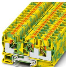
Borna de tierra, número de conexiones: 3, tipo de conexión: Conexión push-in, Sección de dimensionamiento: 10 mm<sup>2</sup>, sección: 0,5 mm<sup>2</sup> - 16 mm<sup>2</sup>, clase de montaje: NS 35/7,5, NS 35/15, color: amarillo-verde
