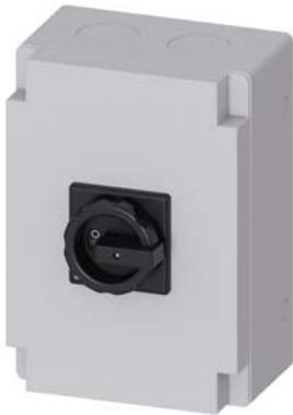
SENTRON, interruptor-seccionador 3LD, interruptor principal, 6 polos, Iu: 63 A, Potencia de empleo / con AC-23 A a 400 V: 22 kW, Caja de material aislante para pasacables métrico, 1NC, 1NA, Accionamiento giratorio, negro
