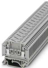
Bornes para termopares, TC tipo J, tensión nominal: 400 V, corriente nominal: 1 A, número de conexiones: 4, número de polos: 2, tipo de conexión: Conexión por tornillo, 1er piso, sección: 0,2 mm<sup>2</sup> - 4 mm<sup>2</sup>, clase de montaje: NS 35/7,5, NS 35/15, NS 32, color: gris
