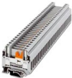
Borne interrumpible, tipo de conexión: Conexión por tornillo, sección: 0,5 mm<sup>2</sup> - 16 mm<sup>2</sup> , AWG: 20 - 8, anchura: 10,2 mm, clase de montaje: NS 35/7,5, NS 35/15, NS 32, color: gris
