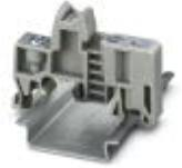
Soporte final, anchura: 9,5 mm, altura: 35,3 mm, material: PA, longitud: 50,5 mm, Montaje sobre carril NS 32 o NS 35, color: gris
