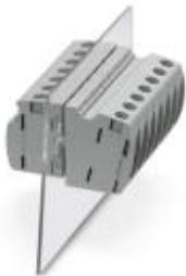
Borne pasamuros, tipo de conexión: Conexión por tornillo con cápsula de tracción, Conexión por tornillo con cápsula de tracción, número de polos: 1, corriente de carga: 76 A, sección: 6 mm<sup>2</sup> - 25 mm<sup>2</sup>, dirección de conexión del conductor con respecto a la dirección de enchufe: 0 °, anchura: 12,1 mm, color: gris
