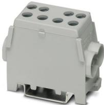
Módulo de ramificación de cable principal, tensión nominal: 400 V, corriente nominal: 125 A, número de conexiones: 4, número de polos: 1, tipo de conexión: Conexión por tornillo, 1er piso, Sección de dimensionamiento: 35 mm<sup>2</sup>, sección: 10 mm<sup>2</sup> - 35 mm<sup>2</sup>, Conexión por tornillo, 2. Piso, sección: 1,5 mm<sup>2</sup> - 25 mm<sup>2</sup>, clase de montaje: NS 35/7,5, NS 35/15, color: gris
