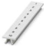
Tira Zack, Tiras, blanco, rotulado, rotulable con: CMS-P1-PLOTTER, Rotulación transversal: números correlativos de 1 ... 10, 11 ... 20 etc. hasta 491 ... 500, clase de montaje: encajar en ranura para índice alta, para ancho de borne: 6,2 mm, superficie útil: 6,15 x 10,5 mm, Número de índices individuales: 10
