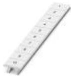
Tira Zack, Tiras, blanco, rotulado, rotulable con: CMS-P1-PLOTTER, Rotulación transversal: números correlativos de 1 ...10, 11 ...20 etc. hasta 91 ...100, clase de montaje: encajar en ranura para índice alta, para ancho de borne: 8,2 mm, superficie útil: 10,5 x 8,15 mm, Número de índices individuales: 10
