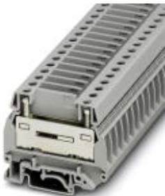
Borne eslabón desliz., sin eslabón deslizante, tensión nominal: 500 V, corriente nominal: 41 A, tipo de conexión: Conexión por tornillo, número de conexiones: 2, sección: 0,5 mm<sup>2</sup> - 10 mm<sup>2</sup>, AWG: 20 - 8, anchura: 8,2 mm, color: gris, clase de montaje: NS 35/7,5, NS 35/15, NS 32
