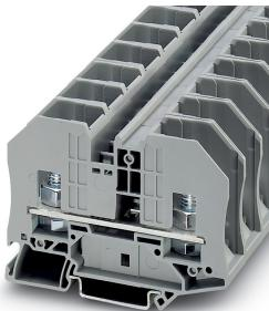
Borne de conexión por espárrago, Importante: en caso de terminales de cable no aislados utilizar la prolongación de trayecto BE-RT... (véase accesorios)., tensión nominal: 1000 V, corriente nominal: 125 A, tipo de conexión: Conexión por espárrago, número de conexiones: 2, número de polos: 1, anchura: 20,3 mm, color: gris, clase de montaje: NS 35/7,5, NS 35/15
