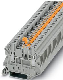
Borne interrumpible por cuchilla, con hembras roscadas para tomas de prueba para alojar clavijas de prueba, tensión nominal: 400 V, corriente nominal: 20 A, tipo de conexión: Conexión por tornillo, número de conexiones: 2, sección: 0,14 mm<sup>2</sup> - 4 mm<sup>2</sup>, AWG: 26 - 12, anchura: 5,2 mm, color: gris, clase de montaje: NS 35/7,5, NS 35/15
