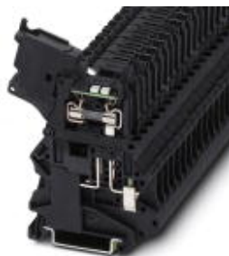
Borne para fusible con palanca, color negro, para cartuchos fusible G de 5 x 20 mm, con LED para 24 V AC/DC
