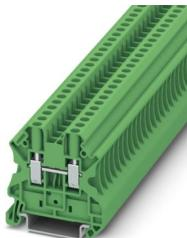
Borne de paso, tensión nominal: 1000 V, corriente nominal: 32 A, número de conexiones: 2, tipo de conexión: Conexión por tornillo, Sección de dimensionamiento: 4 mm<sup>2</sup>, sección: 0,14 mm<sup>2</sup> - 6 mm<sup>2</sup>, clase de montaje: NS 35/7,5, NS 35/15, color: verde
