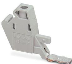
Borna de derivación, tensión nominal: 1000 V, corriente nominal: 32 A, número de conexiones: 1, tipo de conexión: Conexión por tornillo, sección: 0,14 mm<sup>2</sup> - 6 mm<sup>2</sup>, clase de montaje: en elemento de base, color: gris
