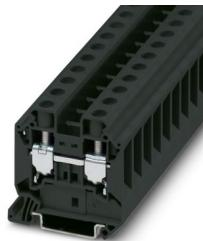
Borne de paso, tensión nominal: 1000 V, corriente nominal: 76 A, número de conexiones: 2, tipo de conexión: Conexión por tornillo, Sección de dimensionamiento: 16 mm<sup>2</sup>, sección: 1,5 mm<sup>2</sup> - 25 mm<sup>2</sup>, clase de montaje: NS 35/7,5, NS 35/15, color: negro
