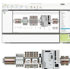
Software de planificación y marcado intuitivo para diseñar regletos de bornes y para la rotulación profesional de materiales de marcado para bornes, conductores, equipos e instalaciones. El software está disponible para su descarga
