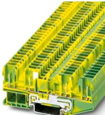
Borne de tierra de conexión por resorte, número de conexiones: 4, tipo de conexión: Conexión enchufable, 1er piso, sección: 0,08 mm<sup>2</sup> - 4 mm<sup>2</sup>, clase de montaje: NS 35/7,5, NS 35/15, color: amarillo-verde
