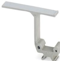
Índice para señalización de grupos, encajable en el centro del borne para bornes de conexión por tornillo, de resorte, "push-in" y de conexión rápida, rotulable con una etiqueta de 24 x 4 mm, o manualmente con el rotulador especial (B-STIFT), en el pie de encaje con ZB 5
