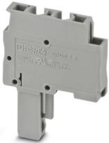
Conector, tensión nominal: 500 V, corriente nominal: 24 A, número de polos: 1, tipo de conexión: Conexión por resorte, Sección de dimensionamiento: 2,5 mm<sup>2</sup>, sección: 0,08 mm<sup>2</sup>- 4 mm<sup>2</sup>, color: gris
