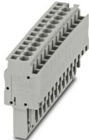
Conector, tensión nominal: 500 V, corriente nominal: 24 A, número de polos: 13, tipo de conexión: Conexión por resorte, Sección de dimensionamiento: 2,5 mm<sup>2</sup>, sección: 0,08 mm<sup>2</sup>- 4 mm<sup>2</sup>, color: gris
