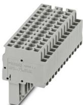
Conector, tensión nominal: 500 V, corriente nominal: 24 A, número de polos: 13, tipo de conexión: Conexión por resorte, Sección de dimensionamiento: 2,5 mm<sup>2</sup>, sección: 0,08 mm<sup>2</sup>- 4 mm<sup>2</sup>, color: gris
