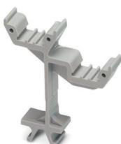
Soporte para señalización, Insertable en las bornas de conexión por resorte ST 2,5, rotulable con UC-TM 5, UC-TMF 5, UCT-TM 5, UCT-TMF 5, ZB 5 o ZBF 5, gris, sin rotular, clase de montaje: enclavar, altura del campo de texto: 10,5 mm, anchura del campo de texto: 5 mm
