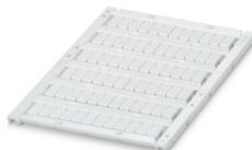
Marcador para bornes, Estera, blanco, sin rotular, rotulable con: TOPMARK NEO, TOPMARK LASER, BLUEMARK ID COLOR, BLUEMARK ID, BLUEMARK CLED, THERMOMARK PRIME, THERMOMARK CARD 2.0, THERMOMARK CARD, clase de montaje: enclavar, para ancho de borne: 5,2 mm, Número de índices individuales: 72, altura del campo de texto: 10,5 mm, anchura del campo de texto: 4,6 mm
