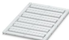
Marcador para bornes, Estera, blanco, sin rotular, rotulable con: TOPMARK NEO, TOPMARK LASER, BLUEMARK ID COLOR, BLUEMARK ID, BLUEMARK CLED, THERMOMARK PRIME, THERMOMARK CARD 2.0, THERMOMARK CARD, clase de montaje: enclavar, para ancho de borne: 5,2 mm, Número de índices individuales: 72, altura del campo de texto: 4,7 mm, anchura del campo de texto: 4,4 mm
