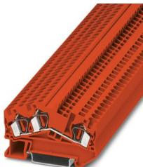
Borne de paso, tensión nominal: 800 V, corriente nominal: 32 A, número de conexiones: 3, tipo de conexión: Conexión por resorte, 1er piso, Sección de dimensionamiento: 4 mm<sup>2</sup>, sección: 0,08 mm<sup>2</sup> - 6 mm<sup>2</sup>, clase de montaje: NS 35/7,5, NS 35/15, color: rojo
