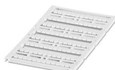
Marcador para bornes, Estera, blanco, sin rotular, rotulable con: BLUEMARK ID COLOR, BLUEMARK ID, BLUEMARK CLED, PLOTMARK, CMS-P1-PLOTTER, clase de montaje: enclavar, para ancho de borne: 5,2 mm, Número de índices individuales: 96, altura del campo de texto: 5,1 mm, anchura del campo de texto: 4,6 mm
