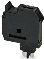
Cabeza portafusible, Antes de sustituir el fusible G, retirar la cabeza portafusible del borne de base., tensión nominal: 500 V, corriente nominal: 6,3 A, tipo de fusible: G/5 x 20, clase de montaje: Montaje por encaje, color: negro
