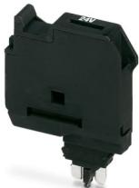
Cabeza portafusible, Antes de sustituir el fusible G, retirar la cabeza portafusible del borne de base., tensión nominal: 500 V, corriente nominal: 6,3 A, tipo de conexión: Conexión enchufable, tipo de fusible: G/5 x 20, clase de montaje: Montaje por encaje, color: negro
