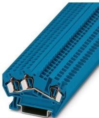
Borne de paso, tensión nominal: 800 V, corriente nominal: 32 A, número de conexiones: 3, tipo de conexión: Conexión por resorte, 1er piso, Sección de dimensionamiento: 4 mm<sup>2</sup>, sección: 0,08 mm<sup>2</sup> - 6 mm<sup>2</sup>, clase de montaje: NS 35/7,5, NS 35/15, color: azul
