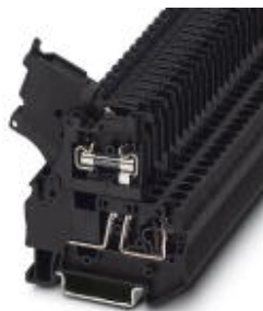
Borne para fusible para montaje sobre NS 35, para cartuchos fusible G de 5 x 20
