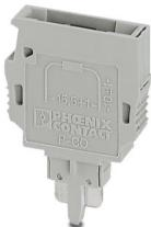
Conector de componentes, con diodo 1N4007, profundidad: 33,3 mm, anchura: 5,2 mm, altura: 24,2 mm, número de polos: 1, color: gris, clase de montaje: Montaje por encaje
