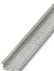
Carril simétrico sin perforar, Variante de embalaje con 25 unidades (50 m), según EN 60715, material: Acero, galvanizado, pasivado de capa gruesa, Perfil estándar, color: plateado
