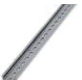
Carril simétrico perforado, Perfil estándar, anchura: 35 mm, altura: 7,5 mm, según EN 60715, material: Acero, Galvanizado, pasivado blanco, longitud: 2000 mm, color: plateado
