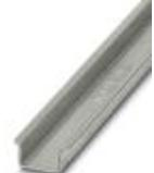
Carril simétrico sin perforar, Perfil estándar 2,3 mm, anchura: 35 mm, altura: 15 mm, según EN 60715, material: Acero, galvanizado, pasivado de capa gruesa, longitud: 2000 mm, color: plateado
