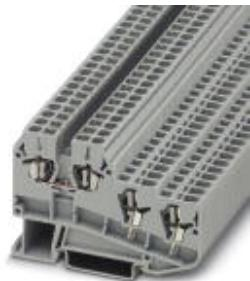
Borne para detectores/actuadores, tipo de conexión: Conexión por resorte, sección: 0,14 mm<sup>2</sup> - 2,5 mm<sup>2</sup>, AWG: 26 - 14, anchura: 5,2 mm, color: gris, clase de montaje: NS 35/7,5, NS 35/15
