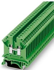
Borne de paso, tensión nominal: 800 V, corriente nominal: 32 A, número de conexiones: 2, tipo de conexión: Conexión por tornillo, Sección de dimensionamiento: 4 mm<sup>2</sup>, sección: 0,2 mm<sup>2</sup> - 6 mm<sup>2</sup>, clase de montaje: NS 35/7,5, NS 35/15, NS 32, color: verde
