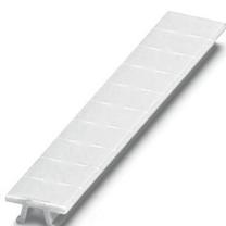
Marcador para bornes, Tiras, blanco, rotulado, rotulable con: CMS-P1-PLOTTER, longitudinal: L1, L2, L3, N, PE, L1, L2, L3, N, PE, clase de montaje: enclavar, para ancho de borne: 6,2 mm, Número de índices individuales: 10, altura del campo de texto: 10,5 mm, anchura del campo de texto: 6,15 mm
