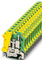
Borna de tierra, número de conexiones: 2, tipo de conexión: Conexión por tornillo, Sección de dimensionamiento: 10 mm<sup>2</sup>, sección: 0,5 mm<sup>2</sup> - 16 mm<sup>2</sup>, tipo de fijación: Pie PE con tornillo de fijación, M4, clase de montaje: NS 35/7,5, NS 35/15, NS 32, color: amarillo-verde
