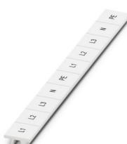
Marcador para bornes, Tiras, blanco, rotulado, rotulable con: CMS-P1-PLOTTER, longitudinal: L1, L2, L3, N, PE, L1, L2, L3, N, PE, clase de montaje: enclavar, para ancho de borne: 10,2 mm, Número de índices individuales: 10, altura del campo de texto: 10,5 mm, anchura del campo de texto: 10,15 mm
