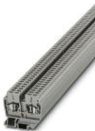
Miniborne de paso, tensión nominal: 800 V, corriente nominal: 24 A, tipo de conexión: Conexión por resorte, número de conexiones: 2, sección: 0,14 mm<sup>2</sup> - 2,5 mm<sup>2</sup>, AWG: 26 - 14, anchura: 5,2 mm, altura: 34 mm, color: gris, clase de montaje: NS 15
