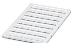
Marcador para bornes, Estera, blanco, sin rotular, rotulable con: BLUEMARK ID COLOR, BLUEMARK ID, BLUEMARK CLED, PLOTMARK, CMS-P1-PLOTTER, clase de montaje: enclavar, para ancho de borne: 6,2 mm, Número de índices individuales: 80, altura del campo de texto: 5,1 mm, anchura del campo de texto: 5,6 mm
