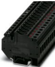
Borne para fusible plano, sección: 0,2-6 mm<sup>2</sup>, AWG: 26-8, anchura: 8,2 mm, color: Negro, con indicación luminosa, tensión indicación luminosa: 24 V DC, corriente indicación luminosa: 2 mA
