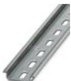
Carril simétrico perforado, Perfil estándar, anchura: 35 mm, altura: 7,5 mm, según EN 60715, material: Acero, galvanizado, longitud: 2000 mm, color: plateado
