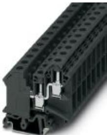
Borne de varios conductores, tensión nominal: 800 V, corriente nominal: 57 A, tipo de conexión: Conexión por tornillo, número de conexiones: 3, sección: 1,5 mm<sup>2</sup> - 16 mm<sup>2</sup>, AWG: 16 - 6, anchura: 10,2 mm, color: azul, clase de montaje: NS 35/7,5, NS 35/15, NS 32
