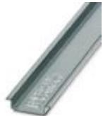
Carril simétrico sin perforar, Perfil estándar, anchura: 35 mm, altura: 7,5 mm, según EN 60715, material: Acero, Galvanizado, pasivado blanco, longitud: 2000 mm, color: plateado
