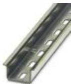
Carril simétrico perforado, Perfil estándar, anchura: 35 mm, altura: 15 mm, similar EN 60715, material: Acero, galvanizado, pasivado de capa gruesa, longitud: 2000 mm, color: plateado
