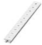
Tira Zack, Tiras, blanco, rotulado, rotulable con: CMS-P1-PLOTTER, rotulación longitudinal: números correlativos de 1 ...10, 11 ...20 etc. hasta 91 ...100, clase de montaje: encajar en ranura para índice alta, para ancho de borne: 10,2 mm, superficie útil: 10,15 x 10,5 mm, Número de índices individuales: 10
