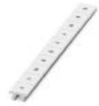
Marcador para bornes, Tiras, blanco, rotulado, rotulable con: CMS-P1-PLOTTER, longitudinal: U, V, W, N, GND, U, V, W, N, GND, clase de montaje: encajar en ranura para índice alta, para ancho de borne: 10,2 mm, superficie útil: 10,15 x 10,5 mm, Número de índices individuales: 10
