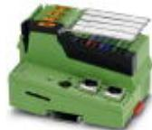
El controlador Inline ofrece la posibilidad de comunicar mediante PROFINET y Modbus/TCP. La programación se realiza con PC Worx Express o PC Worx (IEC 61131-3).
