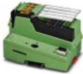
El controlador Inline ofrece la posibilidad de comunicar mediante PROFINET y Modbus/TCP. La programación se realiza con PC Worx Express o PC Worx (IEC 61131-3).
