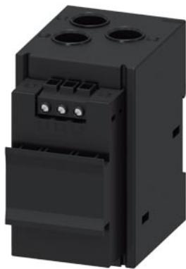
Módulo de medida de intensidad/tensión V2; intensidad de ajuste 10...115 A, medida de tensión hasta 690 V, 55 mm de ancho, transformador con primario pasante, requiere unidad base pro V PB, pro V MR, pro V PN o pro V EIP
