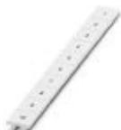
Tira Zack, Tiras, blanco, rotulado, rotulable con: CMS-P1-PLOTTER, Rotulación transversal: números correlativos de 1 ...10, 11 ...20 etc. hasta 91 ...100, clase de montaje: encajar en ranura para índice alta, para ancho de borne: 10,2 mm, superficie útil: 10,15 x 10,5 mm, Número de índices individuales: 10
