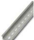
Carril simétrico perforado, Perfil estándar, anchura: 35 mm, altura: 7,5 mm, según EN 60715, material: Acero, galvanizado, pasivado de capa gruesa, longitud: 2000 mm, color: plata
