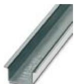
Carril simétrico sin perforar, Perfil estándar, anchura: 35 mm, altura: 15 mm, similar EN 60715, material: Acero, Galvanizado, pasivado blanco, longitud: 2000 mm, color: plateado
