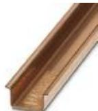
Carril simétrico sin perforar, Perfil estándar, anchura: 35 mm, altura: 15 mm, similar EN 60715, material: Cobre, sin recubrimiento, longitud: 2000 mm, color: de color cobre
