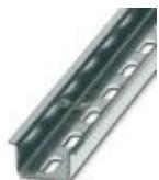
Carril simétrico perforado, Perfil estándar, anchura: 35 mm, altura: 15 mm, similar EN 60715, material: Acero, Galvanizado, pasivado blanco, longitud: 2000 mm, color: plateado
