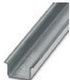
Carril simétrico sin perforar, Perfil estándar, anchura: 35 mm, altura: 15 mm, similar EN 60715, material: Acero, galvanizado, longitud: 2000 mm, color: plateado
