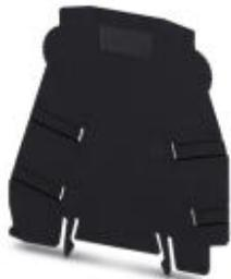
Separador, espesor 2 mm, debe colocarse al principio y al final de cada regleta de bornes PLC. Además, se utiliza para: la separación óptica de grupos, la separación segura de tensiones diferentes de interfaces PLC contiguas según DIN VDE 0106-101, la separación
