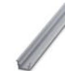
Carril simétrico sin perforar, Perfil estándar, anchura: 35 mm, altura: 15 mm, similar EN 60715, material: Aluminio, sin recubrimiento, longitud: 2000 mm, color: plateado
