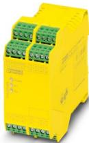
Relé de seguridad para monitorización de paro de emergencia y puertas de seguridad hasta SIL 3 o categoría 4, PL e según EN ISO 13849, funcionamiento monocanal o bicanal, 8 circuitos de disparo,  $U_S = 24$  V DC, borna de tornillo enchufable
