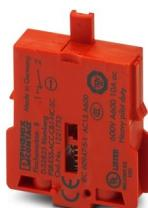
Contactor para interruptor de paro de emergencia modular con contacto de apertura forzada (NC) para la desconexión orientada a la seguridad, en combinación con equipo de evaluación adecuado apto hasta PL e (EN ISO 13849-1), SIL 3 (EN IEC 62061)
