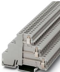
Borna de actuador/sensor de proximidad, tensión nominal: 250 V, corriente nominal: 24 A, tipo de conexión: Conexión por tornillo, 1., 2. y 3er piso, Sección de dimensionamiento: 2,5 mm<sup>2</sup>, sección: 0,2 mm<sup>2</sup> - 4 mm<sup>2</sup>, clase de montaje: NS 35/7,5, NS 35/15, color: gris
