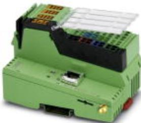
Controlador Inline con interfaz Ethernet y módem GSM para el acoplamiento a otros mandos o sistemas, y posibilidad de programación según IEC 61131-3, completo con conector y superficie de rotulación.
