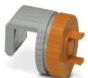
El dispositivo de sujeción opcional ofrece a la bobina Rogowski un alojamiento seguro en barras colectoras con un grosor de 10 ... 15 mm. Durante la instalación, la caja de la bobina se desplaza a la brida del dispositivo de sujeción y se enclava automáticamente.
