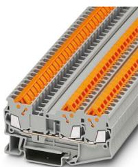
Borne de paso, tensión nominal: 800 V, corriente nominal: 17,5 A, número de conexiones: 3, tipo de conexión: Conexión rápida, 1er piso, Sección de dimensionamiento: 1,5 mm<sup>2</sup>, sección: 0,25 mm<sup>2</sup> - 1,5 mm<sup>2</sup>, clase de montaje: NS 35/7,5, NS 35/7,5, color: gris
