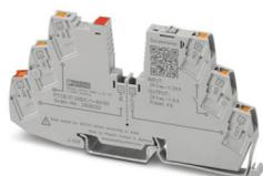
Interruptor electrónico para protección de equipos de 1 canal para proteger consumidores en 24 V DC en caso de sobrecarga y cortocircuito. Distribución de potencial sencilla con los componentes del sistema de bornas para carril CLIPLINE completo. Con bloqueo electrónico de las corrientes nominales ajustadas. Para la instalación sobre carriles DIN.
