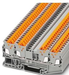
Borne de paso, tensión nominal: 800 V, corriente nominal: 17,5 A, número de conexiones: 4, tipo de conexión: Conexión rápida, 1er piso. Sección de dimensionamiento: 1,5 mm<sup>2</sup>, sección: 0,25 mm<sup>2</sup> - 1,5 mm<sup>2</sup>, clase de montaje: NS 35/7,5, NS 35/7,5, color: gris
