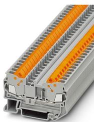
Borne de paso, tensión nominal: 800 V, corriente nominal: 24 A, número de conexiones: 2, tipo de conexión: Conexión rápida, 1er piso, Sección de dimensionamiento: 2,5 mm<sup>2</sup>, sección: 0,5 mm<sup>2</sup> - 2,5 mm<sup>2</sup>, clase de montaje: NS 35/7,5, NS 35/15, color: gris
