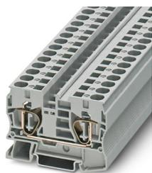
Borne de paso, tensión nominal: 1000 V, corriente nominal: 57 A, número de conexiones: 2, tipo de conexión: Conexión por resorte, Sección de dimensionamiento: 10 mm<sup>2</sup>, sección: 0,2 mm<sup>2</sup> - 16 mm<sup>2</sup>, clase de montaje: NS 35/7,5, NS 35/15, color: gris
