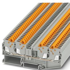
Borne de paso, tensión nominal: 800 V, corriente nominal: 24 A, número de conexiones: 4, tipo de conexión: Conexión rápida, 1er piso, Sección de dimensionamiento: 2,5 mm<sup>2</sup>, sección: 0,5 mm<sup>2</sup> - 2,5 mm<sup>2</sup>, clase de montaje: NS 35/7,5, NS 35/7,5, color: gris
