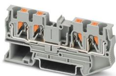
Borne de paso, tensión nominal: 800 V, corriente nominal: 32 A, número de conexiones: 4, tipo de conexión: Conexión push-in, Sección de dimensionamiento: 4 mm<sup>2</sup>, sección: 0,2 mm<sup>2</sup> - 6 mm<sup>2</sup>, clase de montaje: NS 35/7,5, NS 35/15, color: gris
