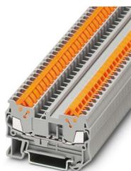
Borne de paso, tensión nominal: 800 V, corriente nominal: 17,5 A, número de conexiones: 2, tipo de conexión: Conexión rápida, 1er piso, Sección de dimensionamiento: 1,5 mm<sup>2</sup>, sección: 0,25 mm<sup>2</sup> - 1,5 mm<sup>2</sup>, clase de montaje: NS 35/7,5, NS 35/15, color: gris
