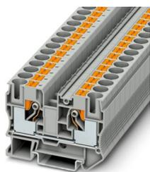
Borne de paso, tensión nominal: 1000 V, corriente nominal: 57 A, número de conexiones: 2, tipo de conexión: Conexión push-in, Sección de dimensionamiento: 10 mm<sup>2</sup>, sección: 0,5 mm<sup>2</sup> - 16 mm<sup>2</sup>, clase de montaje: NS 35/7,5, NS 35/15, color: gris
