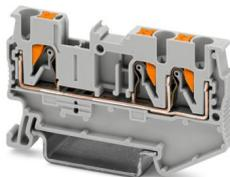
Borne de paso, tensión nominal: 800 V, corriente nominal: 24 A, número de conexiones: 3, tipo de conexión: Conexión push-in, Sección de dimensionamiento: 2,5 mm<sup>2</sup>, sección: 0,14 mm<sup>2</sup> - 4 mm<sup>2</sup>, clase de montaje: NS 35/7,5, NS 35/15, color: gris
