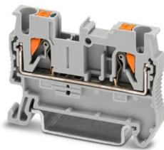
Borne de paso, tensión nominal: 800 V, corriente nominal: 24 A, número de conexiones: 2, número de polos: 1, tipo de conexión: Conexión push-in, Sección de dimensionamiento: 2,5 mm<sup>2</sup>, sección: 0,14 mm<sup>2</sup> - 4 mm<sup>2</sup>, clase de montaje: NS 35/7,5, NS 35/15, color: gris
