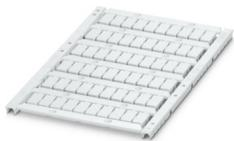
Marcador para bornes, Estera, blanco, sin rotular, rotulable con: TOPMARK NEO, TOPMARK LASER, BLUEMARK ID COLOR, BLUEMARK ID, BLUEMARK CLED, THERMOMARK PRIME, THERMOMARK CARD 2.0, THERMOMARK CARD, clase de montaje: enclavar, para ancho de borne: 6,2 mm, Número de índices individuales: 60, altura del campo de texto: 10,5 mm, anchura del campo de texto: 5,6 mm
