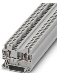
Borne de paso, tensión nominal: 800 V, corriente nominal: 24 A, número de conexiones: 2, tipo de conexión: Conexión por resorte, Sección de dimensionamiento: 2,5 mm<sup>2</sup>, sección: 0,08 mm<sup>2</sup> - 4 mm<sup>2</sup>, clase de montaje: NS 35/7,5, NS 35/15, color: gris
