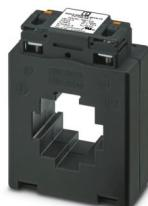
Convertidor de corriente de barra pasante con tecnología de conexión push-in y por tornillo; conexión del conductor con push-in directamente desde arriba y sin herramientas. Se puede elegir: corriente primaria (100 ... 1000) A AC, corriente secundaria (1 o 5) A AC, clase de exactitud 0,5 o 1, potencia VA
