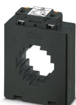
Convertidor de corriente de barra pasante con tecnología de conexión push-in y por tornillo; conexión del conductor con push-in directamente desde arriba y sin herramientas. Se puede elegir: corriente primaria (100 ... 1500) A AC, corriente secundaria (1 o 5) A AC, clase de exactitud 0,5 o 1, potencia VA
