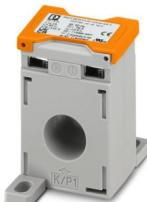
Convertidor corriente tubo incorporado, corriente primaria seleccionable de 50...500 A CA; corriente secundaria seleccionable 1 A CA o 5 A CA; clase de precisión seleccionable 0,5 o 1; potencia de dimensionamiento seleccionable
