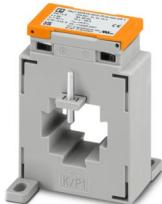
Transformador corriente de barra pasante, corriente primaria seleccionable de 75...1000 A CA; corriente secundaria seleccionable 1 A CA o 5 A CA; clase de precisión seleccionable 0,5 o 1; potencia de dimensionamiento seleccionable
