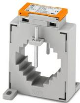
Convertidor de corriente de barra pasante, corriente primaria seleccionable de 200 ... 1250 A AC; corriente secundaria seleccionable de 1 A AC o 5 A AC; clase de exactitud seleccionable de 0,5 o 1; potencia nominal seleccionable
