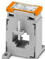
Transformador corriente de barra pasante, corriente primaria seleccionable de 50...750 A CA; corriente secundaria seleccionable 1 A CA o 5 A CA; clase de precisión seleccionable 0,5 o 1; potencia de dimensionamiento seleccionable
