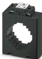
Convertidor de corriente de barra pasante con tecnología de conexión push-in y por tornillo; conexión del conductor con push-in directamente desde arriba y sin herramientas. Se puede elegir: corriente primaria (200 ... 1600) A AC, corriente secundaria (1 o 5) A AC, clase de exactitud 0,5 o 1, potencia VA
