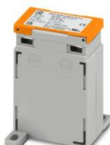
Transformador de primario bobinado, corriente primaria seleccionable de 1...40 A CA; corriente secundaria seleccionable 1 A CA o 5 A CA; clase de precisión seleccionable 0,5 o 1; potencia de dimensionamiento seleccionable
