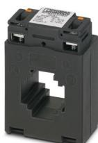
Convertidor de corriente de barra pasante con tecnología de conexión push-in y por tornillo; conexión del conductor con push-in directamente desde arriba y sin herramientas. Se puede elegir: corriente primaria (50 ... 750) A AC, corriente secundaria (1 o 5) A AC, clase de exactitud 0,5 o 1, potencia VA
