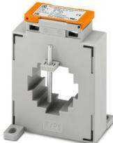
Transformador corriente de barra pasante, corriente primaria seleccionable de 100...1500 A CA; corriente secundaria seleccionable 1 A CA o 5 A CA; clase de precisión seleccionable 0,5 o 1; potencia de dimensionamiento seleccionable
