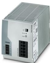
Fuente de alimentación TRIO conmutada en primario para el montaje sobre carril DIN, entrada: trifásica, salida: 24 V DC/40 A, boost dinámico, tecnología de conexión rápida sin herramientas para cables rígidos y flexibles con puntera
