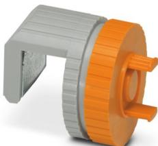
El dispositivo de sujeción opcional ofrece a la bobina Rogowski un alojamiento seguro en barras colectoras con un grosor de 10 ... 15 mm. Durante la instalación, la caja de la bobina se desplaza a la brida del dispositivo de sujeción y se enclava automáticamente.
