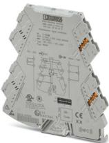
Convertidor de posición de potenciómetro configurable con técnica de conexión enchufable para la conexión de potenciómetros de  $0 \Omega \dots 100 \Omega$  a  $0 \text{ k}\Omega \dots 100 \text{ k}\Omega$ . Configurable a través del interruptor DIP o del software. Técnica de conexión por tornillo, configuración estándar
